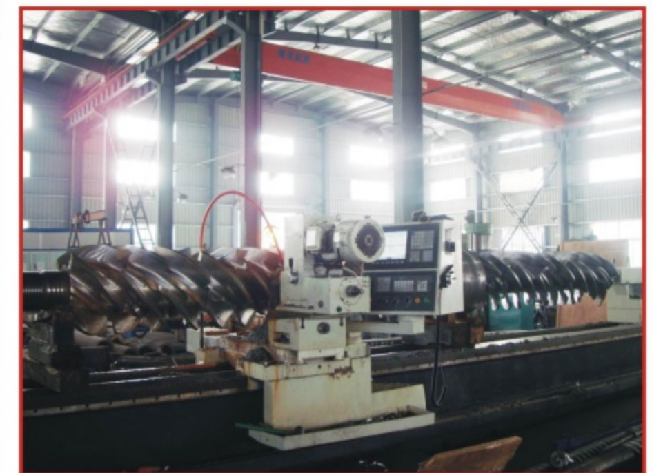
XPS-500特大型螺杆 (孔径φ500, 长10000)
