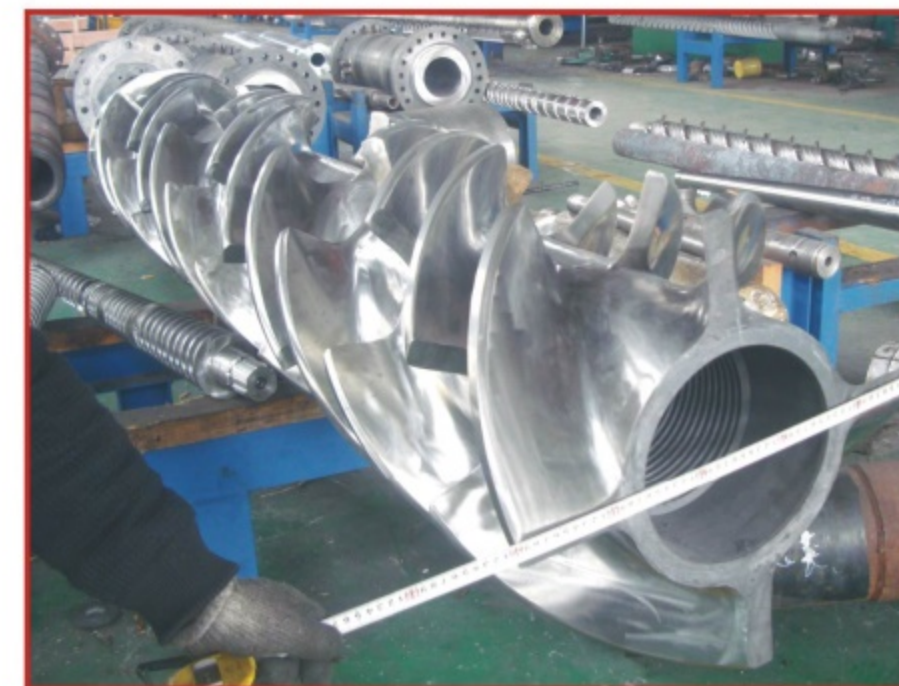
XPS-500特大型螺杆 (孔径φ500, 长10000)
