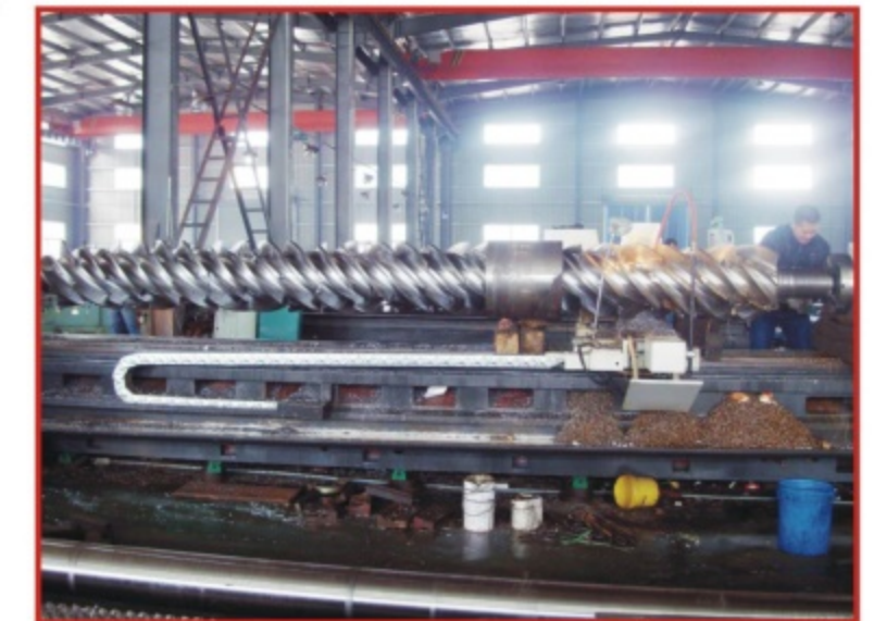
XPS-500特大型螺杆加工 (孔径φ500, 长10000)
